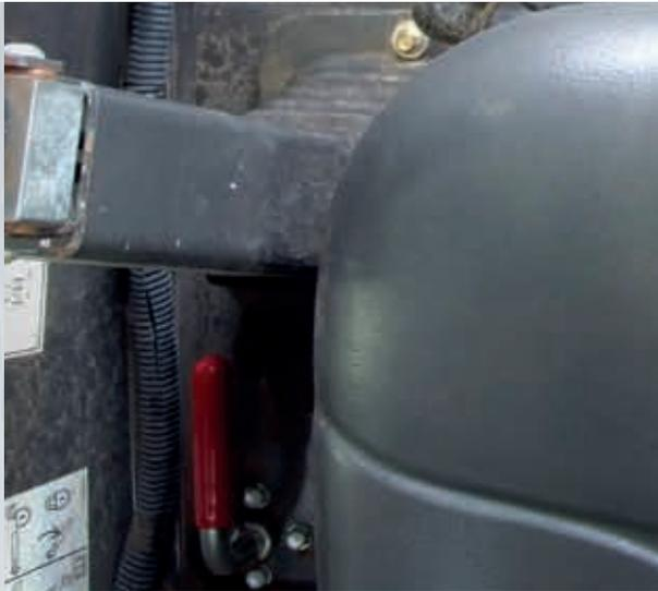
El operador podrá acoplar y desacoplar el bloqueo del brazo desde adentro de la cabina para dar más seguridad al arrancar la máquina con el brazo elevado.
