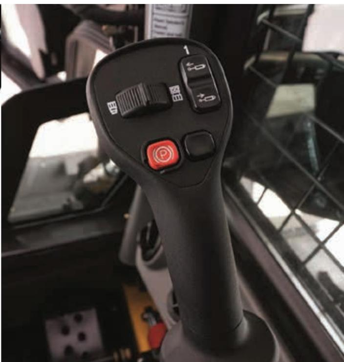
Los interruptores están posicionados en las palancas de control permitiendo la operación fácil de recursos como bocina, flujo proporcional, luces de dirección, dos velocidades, fluctuación de la cuchara, controles múltiples funcionales de los accesorios y el LTS (Load Travel Stabilizer).
