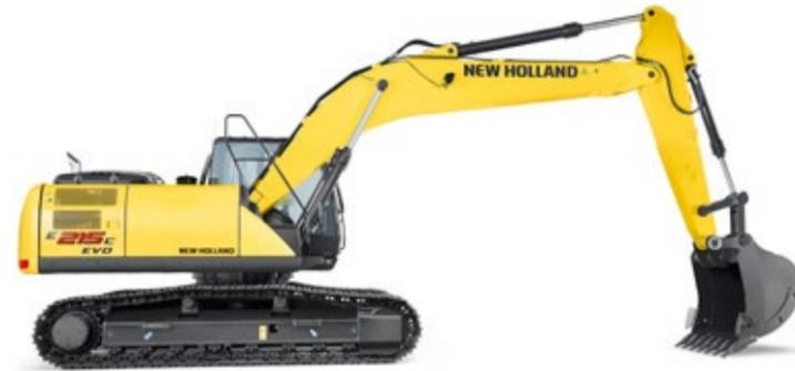
Por otro lado, su brazo y lanza HD poseen un espesor de chapas que permite resistencia y durabilidad en aplicaciones severas como cantera, minería y todo tipo de construcción.
