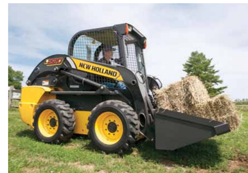
El ángulo de descarga de 53 grados en las minicargadoras serie 200 permite que la cuchara se vacíe más rápido.
