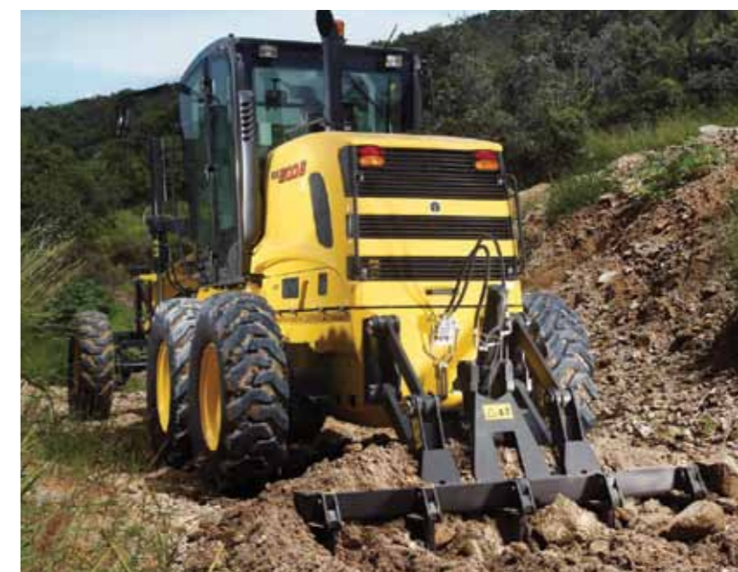
Las motoniveladoras poseen transmisión automática, tipo Powershift, de control eléctrico.
