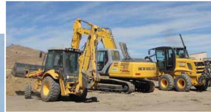
La retroexcavadora B-110B, la motoniveladora RG-200 y la excavadora E-215B, tres de los equipos que trabajan en Viacha.
