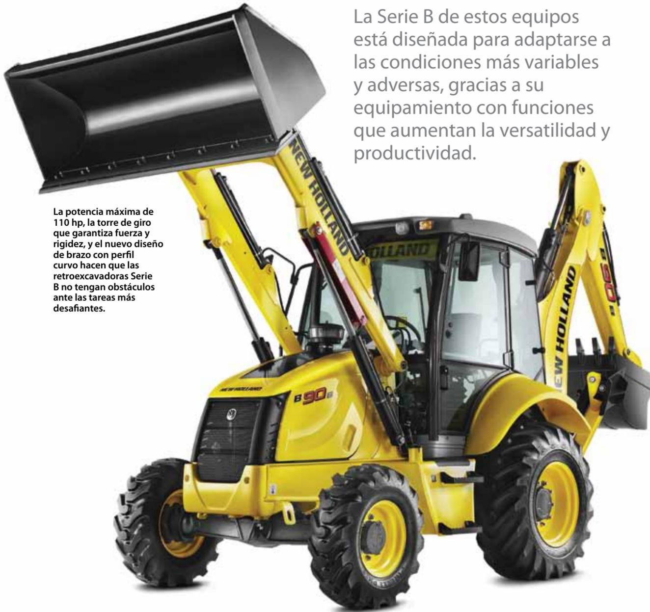
La potencia máxima de 110 hp, la torre de giro que garantiza fuerza y rigidez, y el nuevo diseño de brazo con perfil curvo hacen que las retroexcavadoras Serie B no tengan obstáculos ante las tareas más desafiantes.
